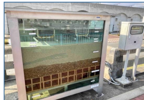
きゅうそくすな かち も けい 急速砂ろ過池模型
